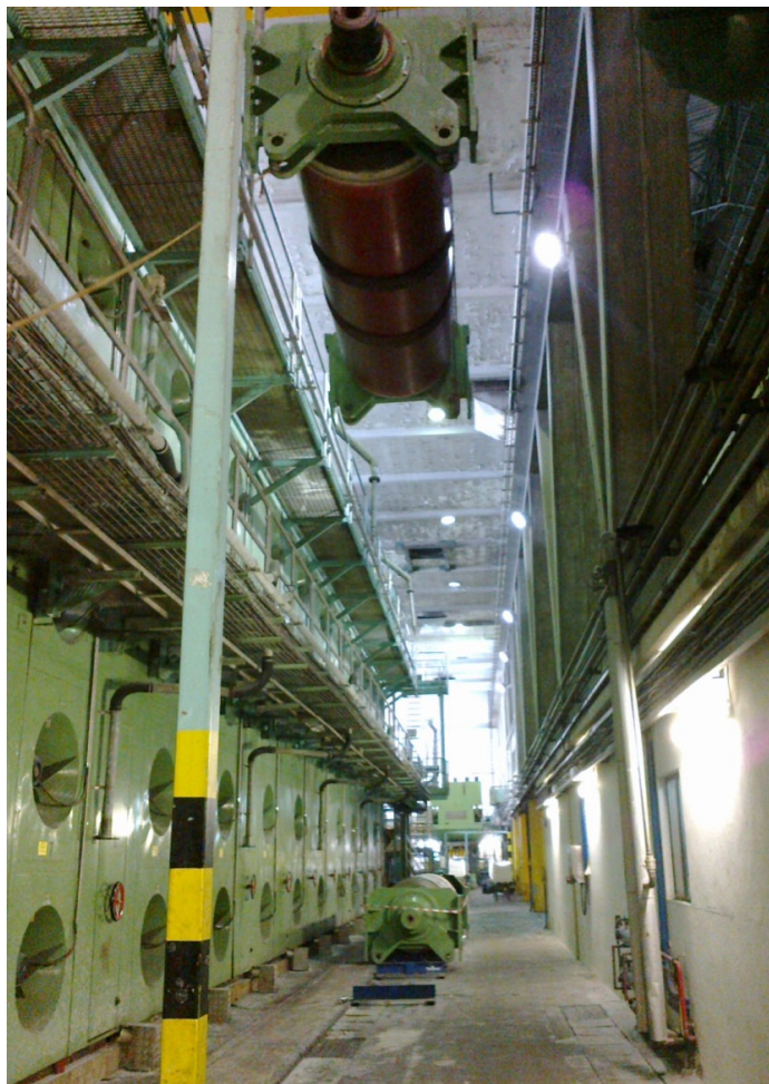
Figura 29 – Rolo a ser transportado para o solo
