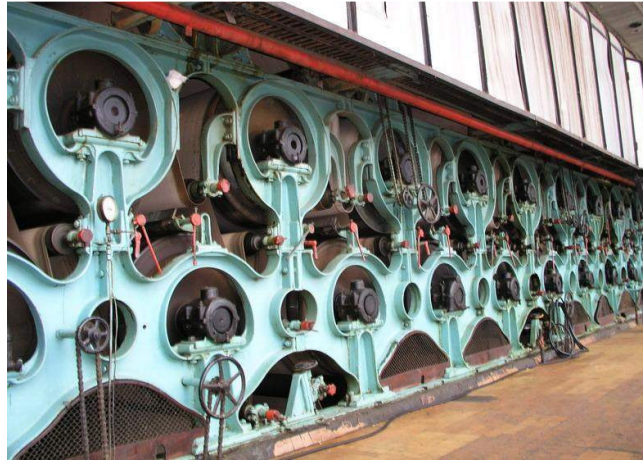
Figura 19 - Secadores in www.horizon.ee , consultado a 16 de Novembro de 2012
