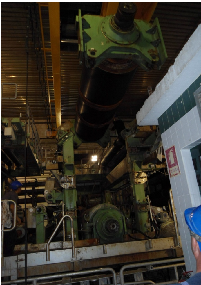
Figura 28 - O rolo já suspenso, após ser retirado
