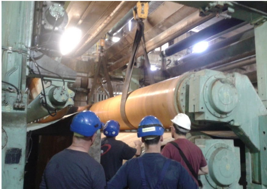
Figura 27 - O rolo a ser suspenso da prensa através de cintas e ponte rolante
