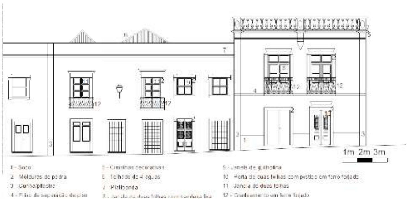
Fig.4.1.7 Exemplo de um conjunto de edifícios de dois pisos com cornija, platibanda, telhado de quatro águas e vãos característicos do século XIX [Adaptado de CORREIA, A.]
