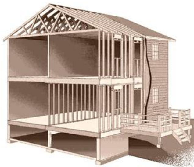
Figura 3 - Edificação em madeira no Sistema Estrutural Leve
