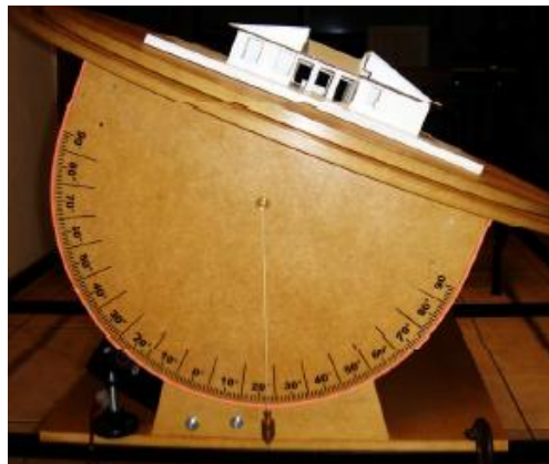
Figura 6: Transferidor (latitudes) do Laboratório de Conforto Ambiental da EESC/USP [Retirado de: CHVATAL; REGULÃO, 2010]
