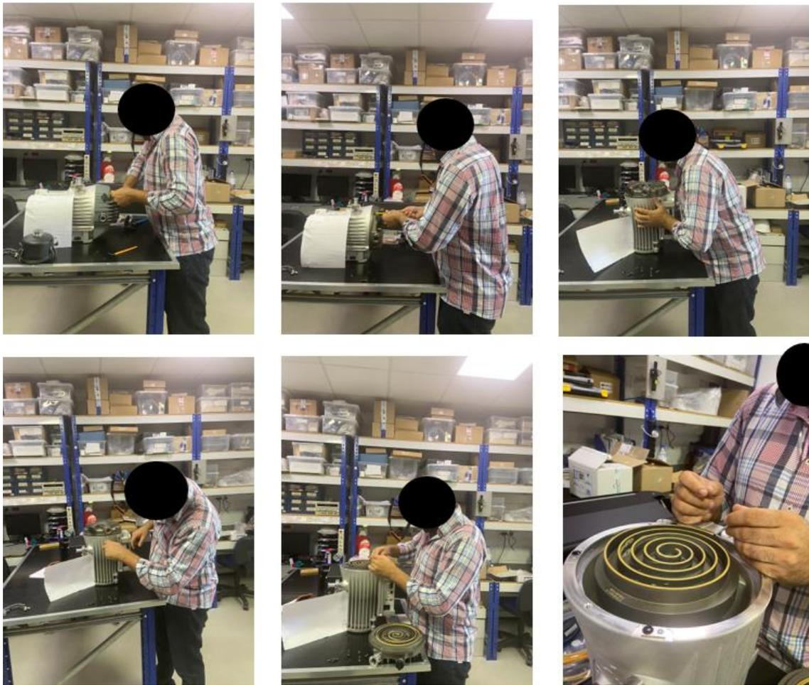
Figura 14 - Manutenção de uma bomba de Vácuo, Técnico 4
