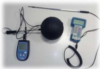
Figura 2- Equipamentos utilizados para medição do conforto térmico (Fonte: Própria, 2025)
