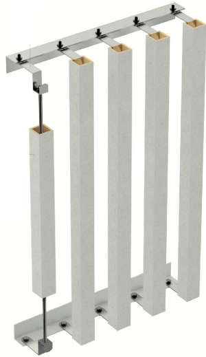
Esquema de fixação dos perfis retangulares do acabamento da fachada ventilada
