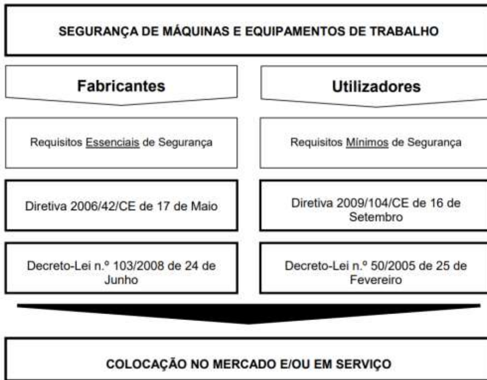
Figura 15 - Enquadramento legislativo para máquinas e equipamentos no trabalho (Fonte: Associação dos Industriais Metalúrgicos, 2015)
