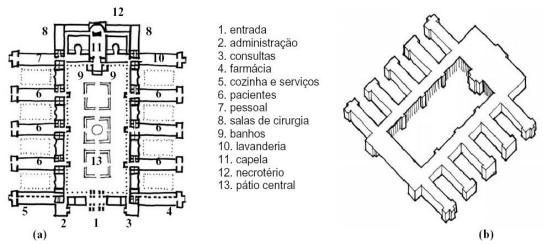
Figura 3 - Hospital Lariboisiere, Paris, 1846-1854. (a) Planta; (b) axonometria. [Fonte: MIQUELIN *apud* MATOS, Rodrigo – *Circulações em Hospitais*,2008]
