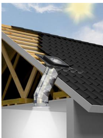
Figura 177: Sky Tunnel , visualização da sua colocação.
