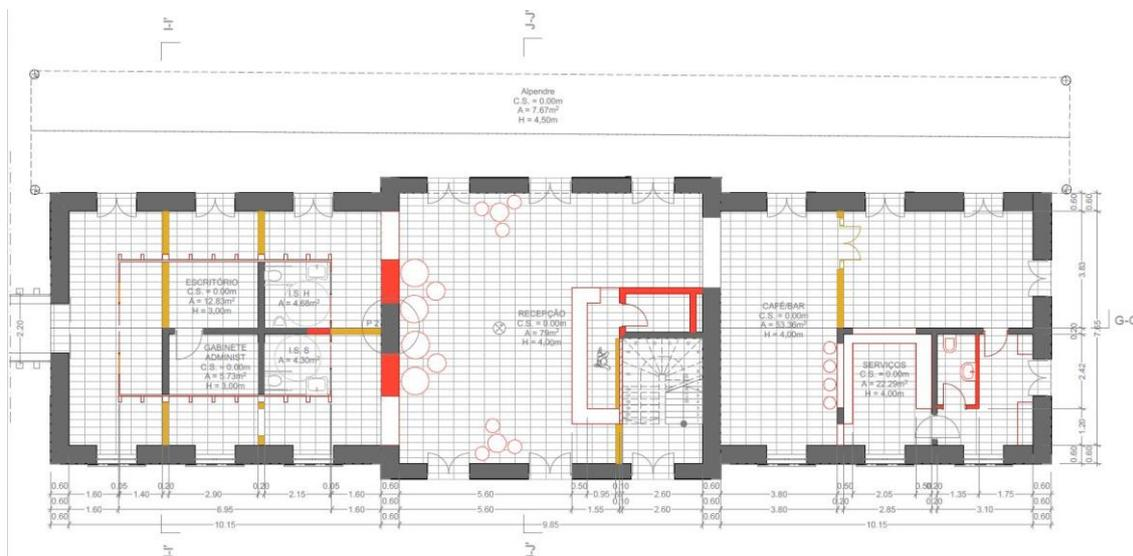
Fig. 103 \_ Planta do piso 0 da proposta. Fonte: autor
