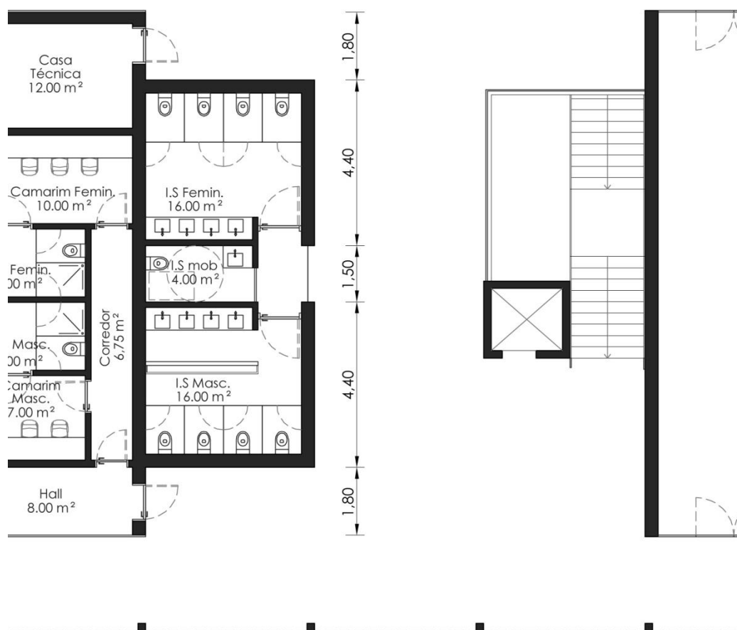
Figura 30 – Planta de instalação sanitária pública Pelo autor
