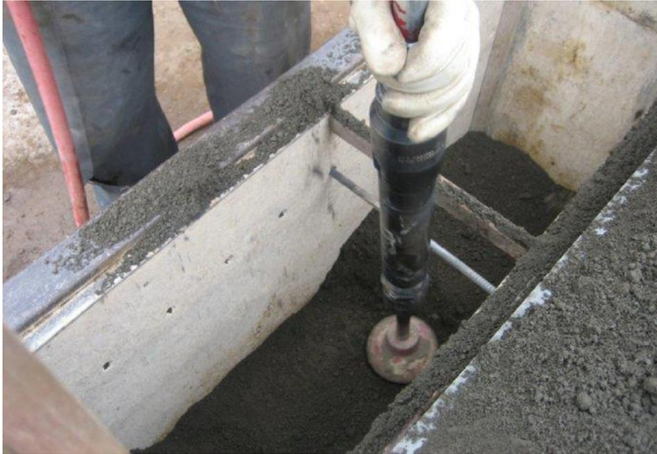
Fig. 34 - Utilização de martelo pneumático.
