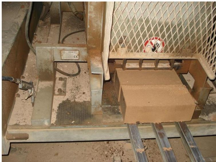
Fig. 43 - Linha de fabrico de BTC, processo de compactação.
