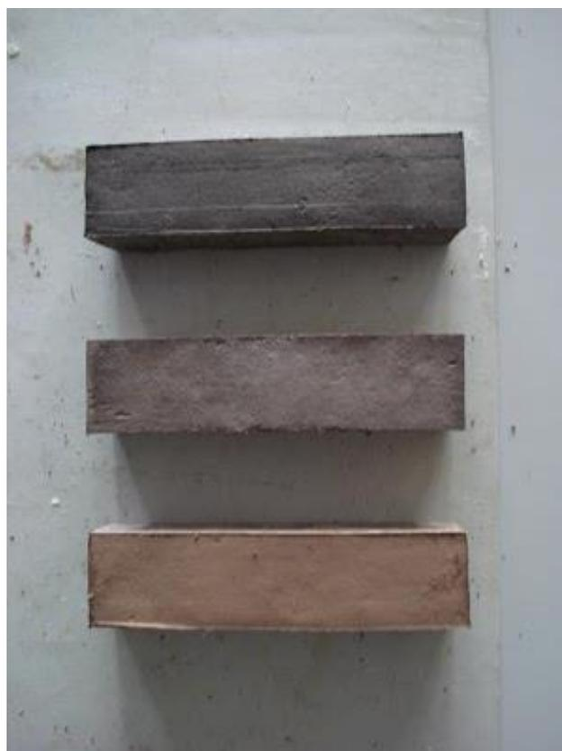
Fig. 44 - Tijolos de terra com fibra de lã
