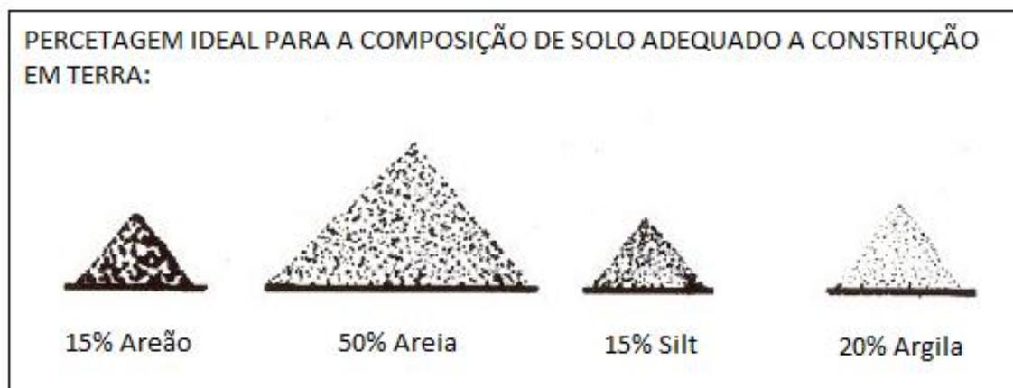
Fig. 9 -Percentagem adequada de componentes da terra para construção.
