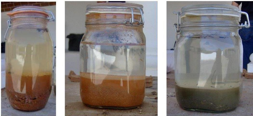
Fig. 10 - Teste da sedimentação de três tipos de solos.
