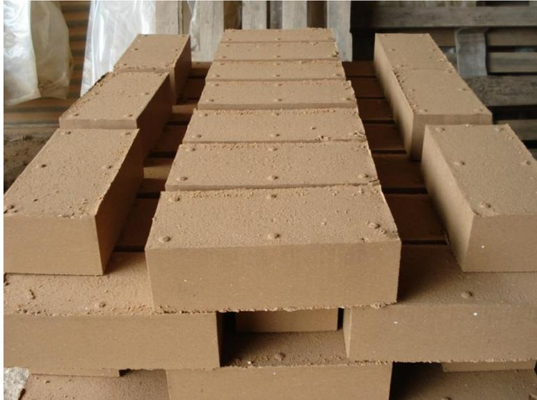
**Fig. 15 - Blocos de terra compactada, Fabrica Carrapateira**
