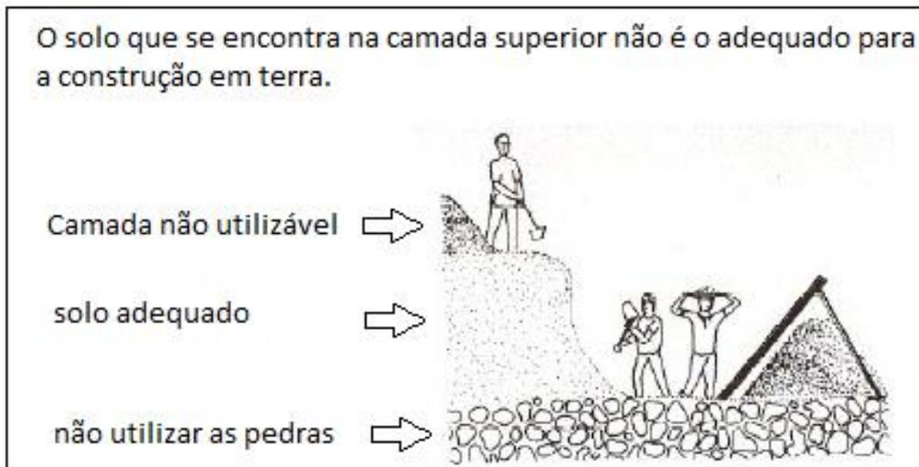
Fig. 8 - Definição de camadas de solo.
