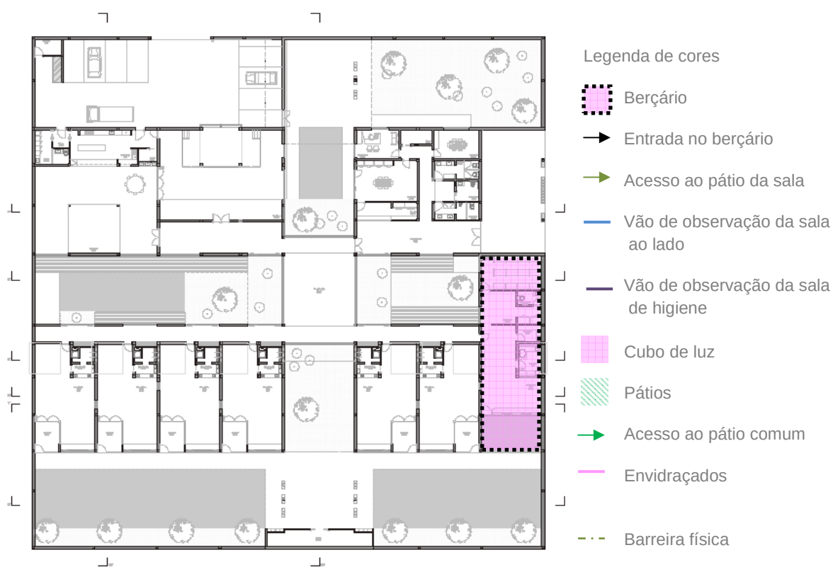
Fig. 226 – Planta com destaque na zona do Berçário
