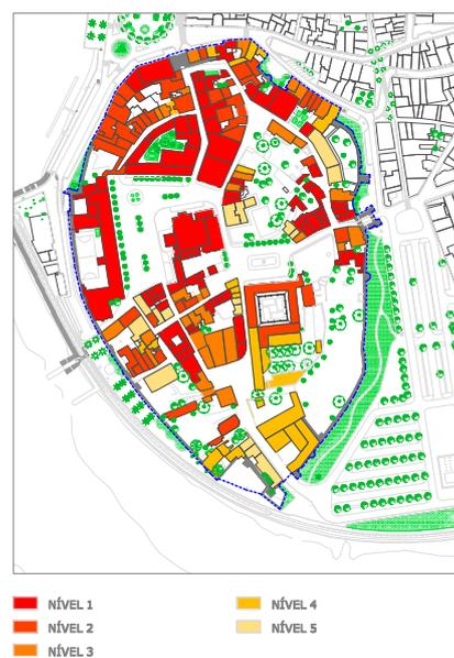
Figura 9 Esquema do Centro Histórico de Faro, 2013. Representação do estado de conservação do edificado.
