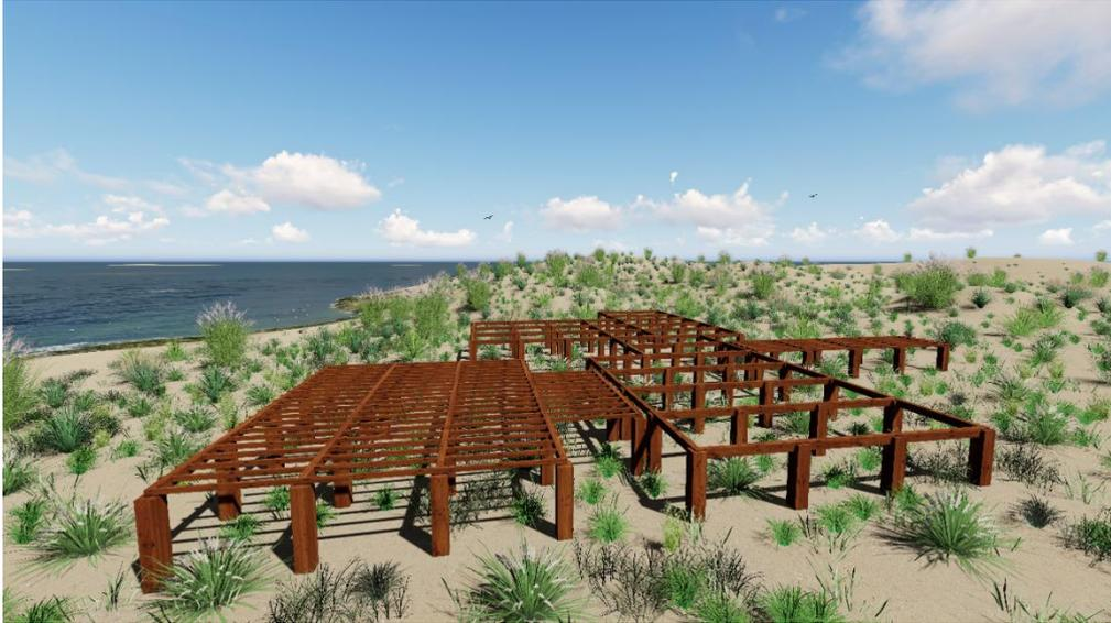
Figura 44 - Modelação 3D, alojamento T2, vigas de pavimento - vista 2.
