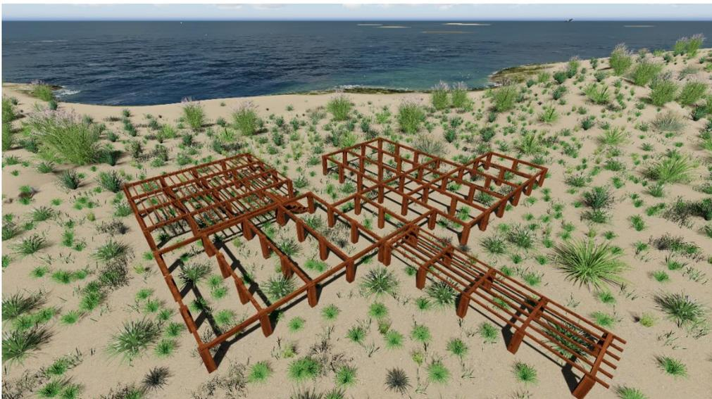
Figura 43 - Modelação 3D, alojamento T2, vigas de pavimento - vista 1.
