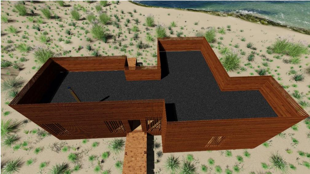
Figura 58 - Modelação 3D, alojamento T2, cobertura revestida a tela asfáltica de xisto.
