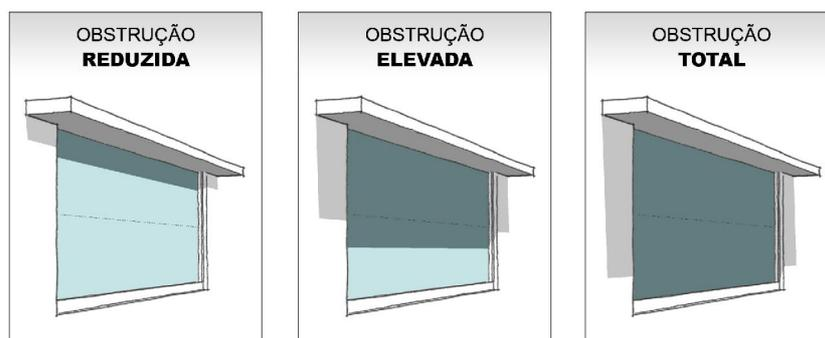
*Fig. 5.1 - Ilustração dos três níveis de obstrução das superfícies não opacas.*
