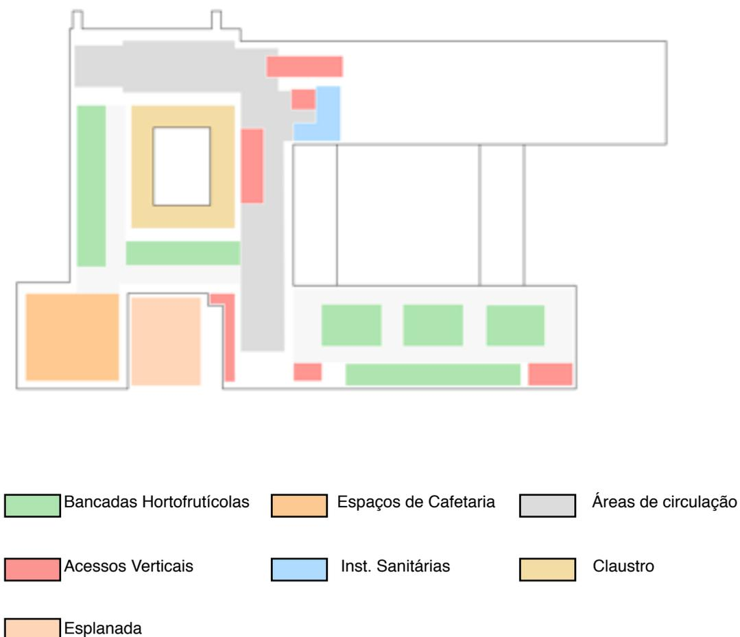
Fig. 42 - Distribuição funcional da proposta referente ao Piso 1
