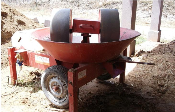
Fig. 108 - Motocultivadora utilizada na mistura da terra.
