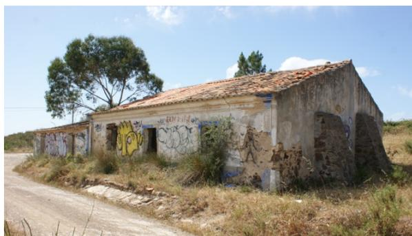
Fig. 33 - Casa em Maria Vinagre. Exemplo de elementaridade, duas águas sem chaminé, ripado de cana, alvenaria de taipa, chão de terra batida, contrafortes e volume alongado. O galinheiro e o forno encontram-se separados. Os estábulos e o alpendre ficam a norte.
