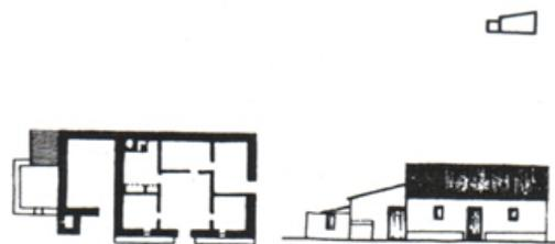
Fig.11 - "Habitação em profundidade e em fila nas vilas de Olhão e Fuseta; açoteias utilizáveis sob as abóbodas de tijoleira cobrindo o rés-do-chão e no 1º andar sobre dormentes; pavimentos em tijoleira; acessos à açoteia pelo pátio posterior."
