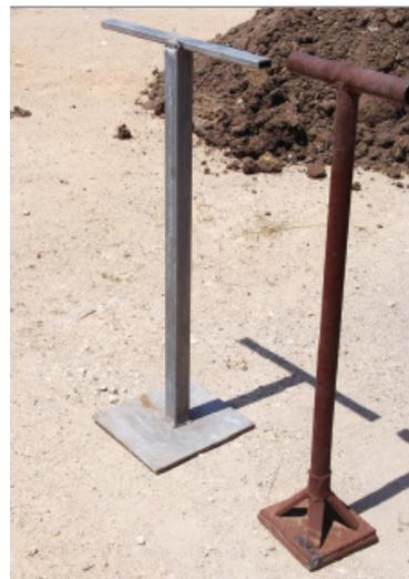
Fig. 111 - Dois maços em metal que agora também se utilizam na compactação da terra. O resultado não pode ser o mesmo. [Fonte: fotografia de Maria da Ponte.]
