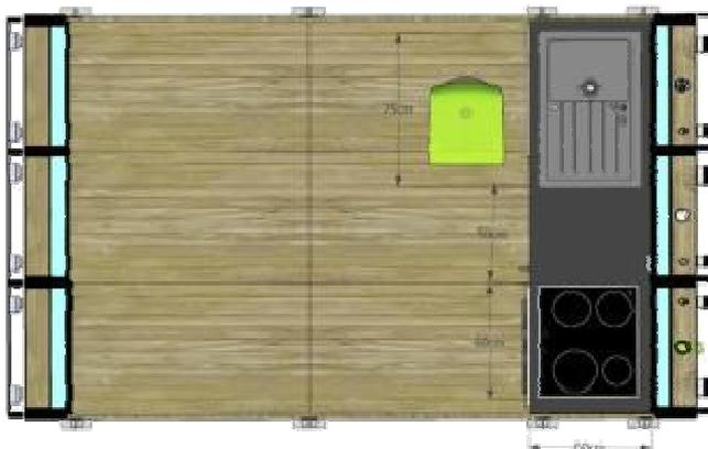
Fig. 65 – Planta do módulo M1 – E:1/50
