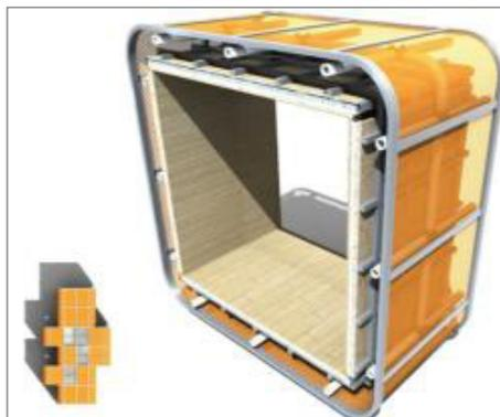
Fig. 50 - Detalhe construtivo da SLIDING HUB.
