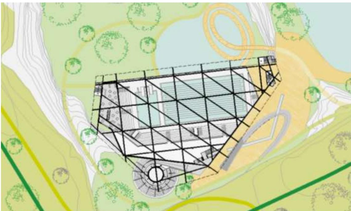
**Fig. 89** Planta da estrutura metálica da cobertura.
