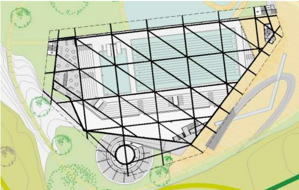
**Fig. 96** Planta da estrutura metálica da cobertura e de sustentação da rampa do visitante.
