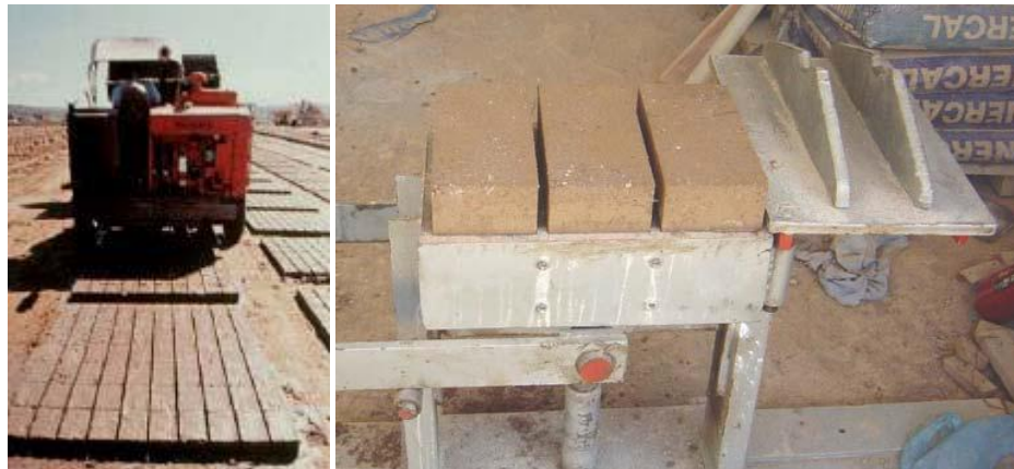
Figura 62 – Fabrico de adobes de forma mecânica e Prensa manual
