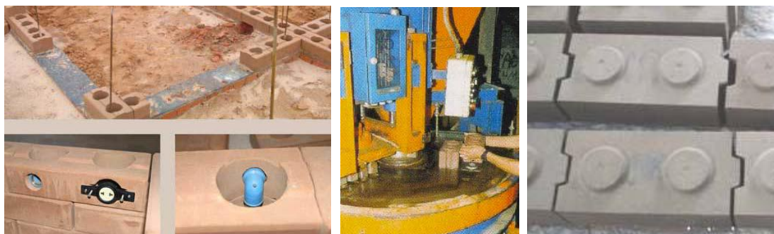
Figura 64: BTC perfurado Prensa hidráulico e maciço
